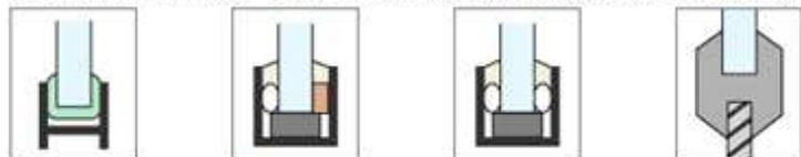
バテ、埋こビード     ゴム+弾性シーラント施工     発泡材+弾性シーラント施工     構造ガasket施工
